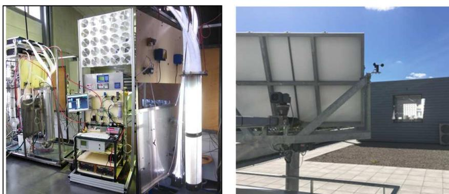
Figure 1 - a) Installation complète en « lumière artificielle » avec les 977 fibres optiques éclairées, et le panneau de lentilles de Fresnel pour la concentration du soleil. b) Héliostat permettant de diriger la lumière du soleil sur le panneau de lentilles de Fresnel
